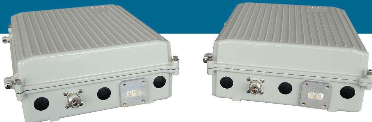
Come gli Up Converter, anche i Down Converter sono generalmente proposti nella versione di scatola a tenuta per ambienti esterni. Questo permette un montaggio più vicino all'antenna minimizzando le perdite dovute al cablaggio.
