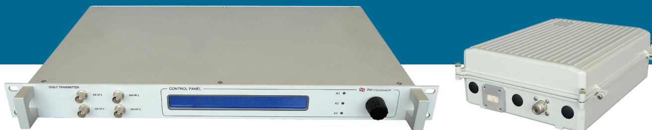
Il modello TT141 si compone di un modulatore DVB-T in formato rack 19" 1U collegato ad una testata esterna di up conversion. Il modulatore presenta 4 ingressi ASI, attraverso i quali è possibile modulare 2 flussi secondo la modalità gerarchica: uno HP (High Priority) e uno LP (Low Priority).
