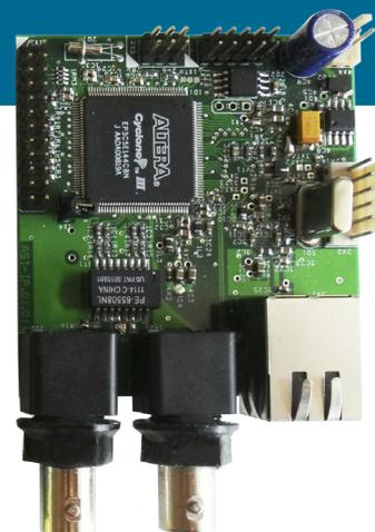
Il sistema di codifica MPEG-2 con uscita IP è in grado di codificare fino a 4 ingressi audio/video e fornire uno flusso UDP/IP in uscita contenente il Transport Stream dei 4 canali. È proposto come una serie di moduli che permettono una facile integrazione in soluzioni esistenti.
