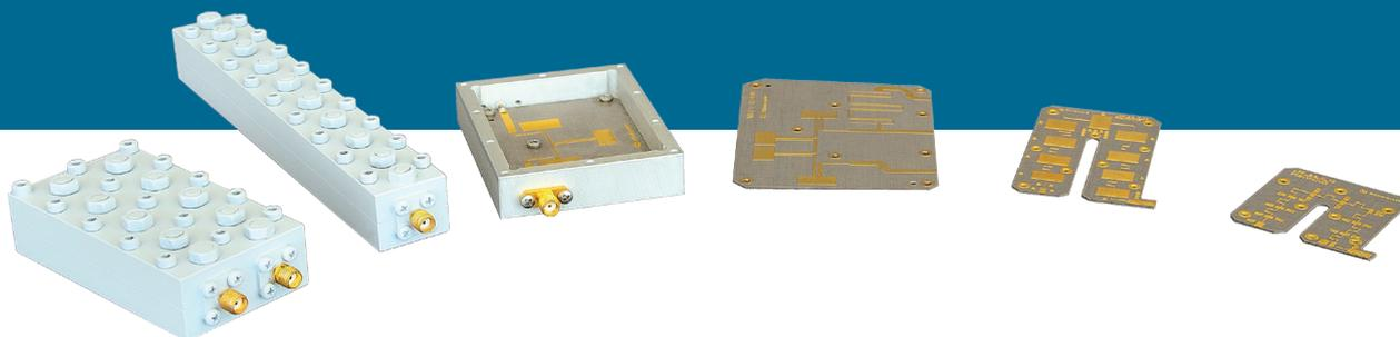
I filtri passa basso che PM Microwave è in grado di realizzare spaziano da strutture coassiali in aria a circuiti a costanti concentrate e distribuite. Come per i filtri passa banda, anche i filtri passa basso vengono progettati e sviluppati ad hoc per il cliente, in modo tale da poter proporre sempre la soluzione tecnologicamente ed economicamente più adatta.
