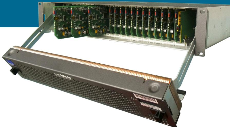
Questo prodotto è un potente e compatto ricevitore e demodulatore COFDM (DVB-T) diversity equipaggiato con 2 uscite ASI e una connessione ETHERNET.
